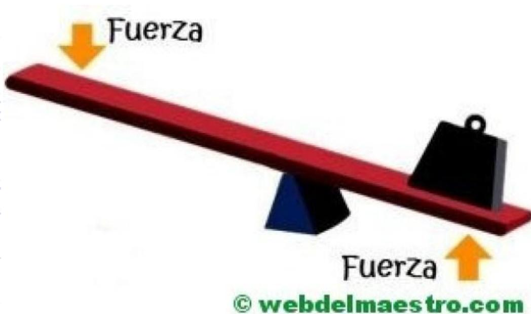
Una **palanca** es una barra o viga rígida, apoyada sobre un soporte (pivote), que permite levantar o mover objetos pesados empleando menos fuerza. Al soporte se le llama punto de apoyo. A cada una de las partes que quedan a los lados del punto de apoyo se le llama brazo. El brazo más corto realiza un recorrido menor que el largo y ejerce mucha más fuerza sobre el objeto.
